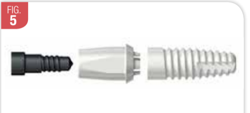
Implant Nobel Pearl en 2 pièces, les composants prothétiques sont en zirconie et la vis Vicarbo est constituée d'un mélange de PEEK et fibres de carbone
